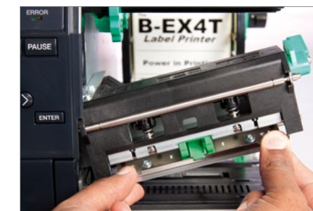
Druckkopf mit „Snap-In“-Verschluss reduziert Wartungszeiten auf ein Minimum
